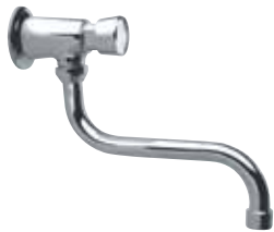
TE 53 Rubinetto frontale temporizzato, con canna "S", 1/2", in ottone cromato, tempo d'apertura 6-8 secondi.
